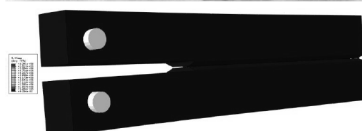
NACE TM0177标准 D法 双悬臂梁试验
