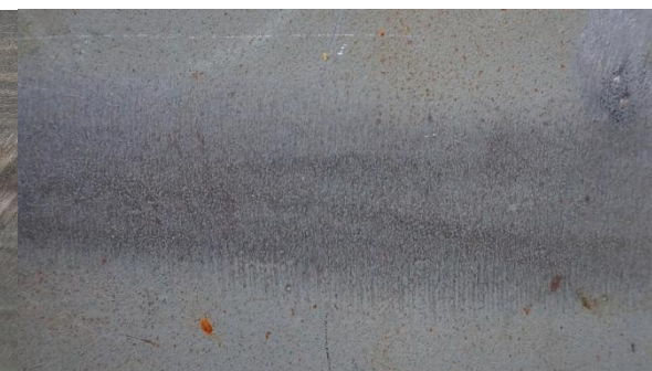
C1.3 火工后底漆动力打磨 St2
