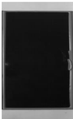
双组份水性环氧铁红漆 STW703A/STW703B配套 两道施工：60-80um 耐盐雾：600小时
