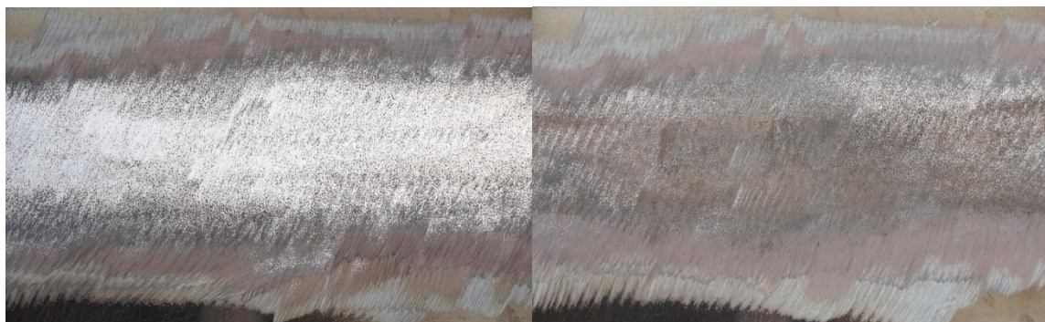
D1.2 火工后完工涂层动力打磨 St3
