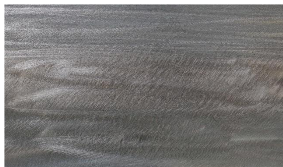
C1.2 火工后底漆动力打磨 St3
