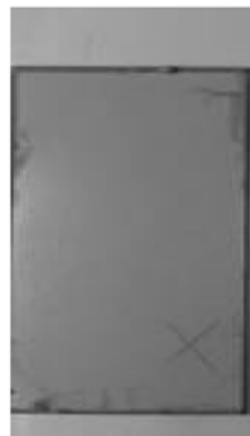
双组份水性环氧漆 底为双组份水性环氧富锌配套 两道施工：80-120um 耐盐雾：1000小时
