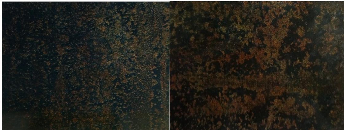
锈蚀等级 B 级 St2 与 St3 的图片对比
